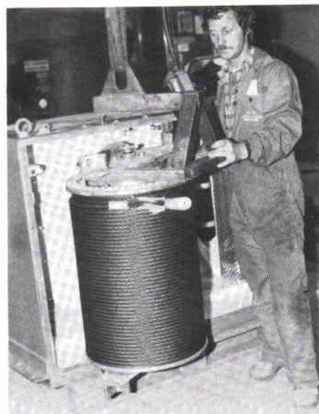
Bengt Erik Olofsson FFV-U/CVÖ lyfter in den ena trumman i bromsenheten för det nya utrullningshindret. Lyftanordningen är fö hans egen konstruktion och senaste bidrag till förslagsverksamheten.
