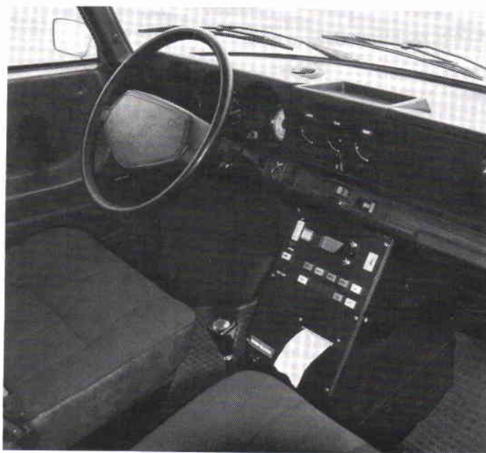
Friktionsmätbilens instrumentpanel sitter till höger om föraren. Diagrammet kommer ut nedtill till höger.
